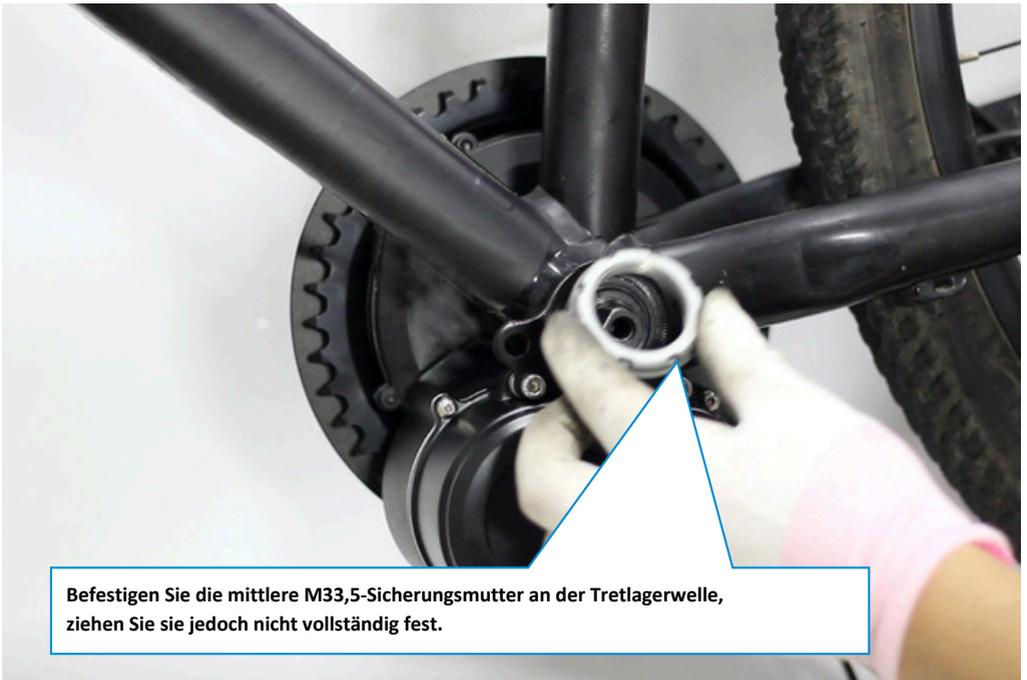
Befestigen Sie die mittlere M33,5-Sicherungsmutter an der Tretlagerwelle, ziehen Sie sie jedoch nicht vollständig fest.
